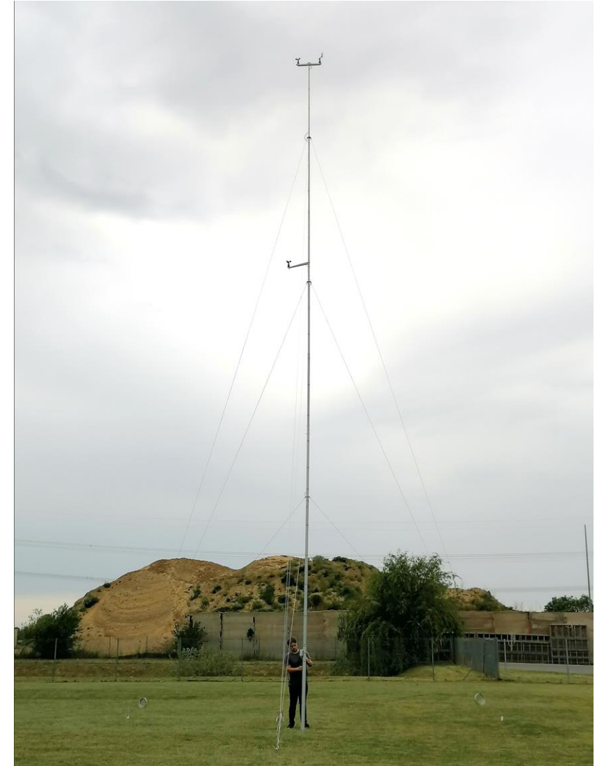
Mastsystem für Windmessungen Quelle: EnMaS
